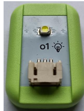
Płytką diody LED „o1”
