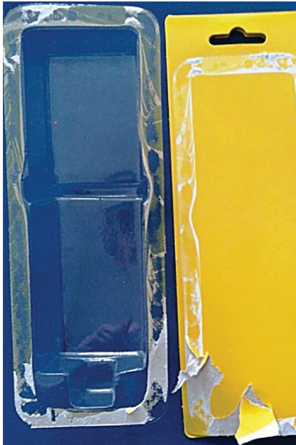
Fot. 1. Opakowanie typu blister pack po próbie rozdzielenia materiałów (na folii widoczne są liczne włókna celulozowe)
