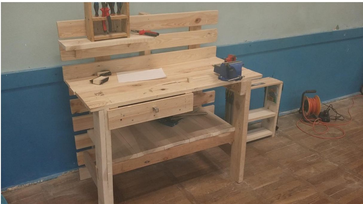
Fot. 10. Stół warsztatowy – tu już z zamontowaną szufladą na „drobiazgi” imadłem - gotowy do użytku.
