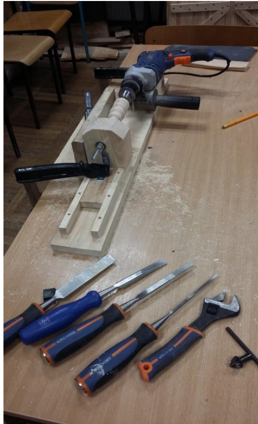
Fot.29. Tokarka – widok z boku. Tu widać konstrukcję i sposób zamocowania konika.
