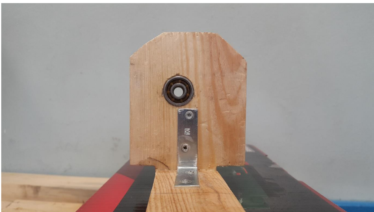
Fot. 37. Tył konika – łożysko i kątownik mocujący deseczkę służącą za podstawę.
