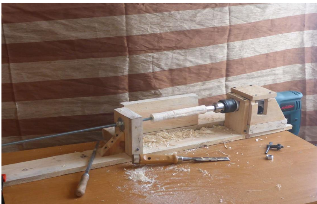
Fot.23. Model mini tokarki w trakcie montażu
