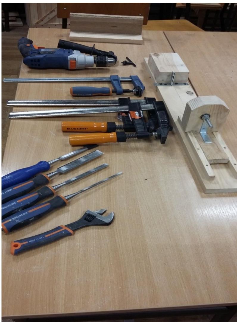
Fot. 40. Mini tokarka po zdemontowaniu
