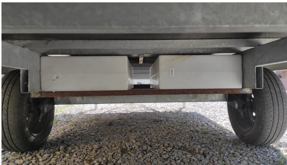
Fotografia nr 16. Zbiorniki na wodę szarą
